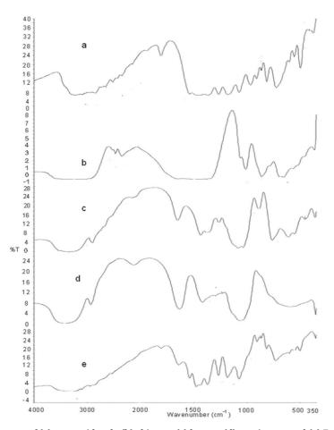
Fig. 1: FTIR spectra of (a) metronidazole (b) chitosan (c) lactose (d) acacia gum and (e) Formulation F2
