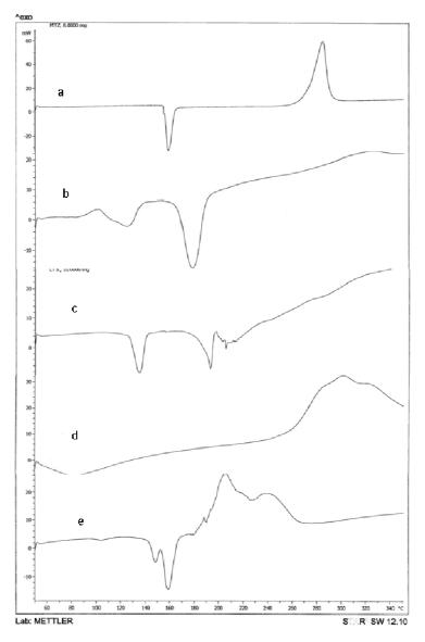
Fig. 2: DSC thermograms of (a) metronidazole (b) chitosan (c) lactose (d) acacia gum and (e) Formulation F2
